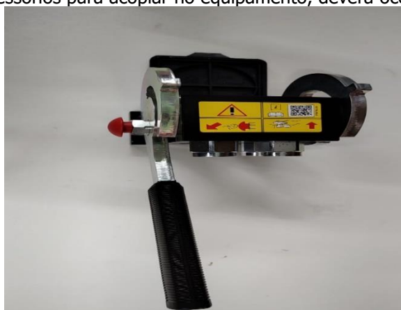
Lateral do engate rápido hidráulico da máquina
